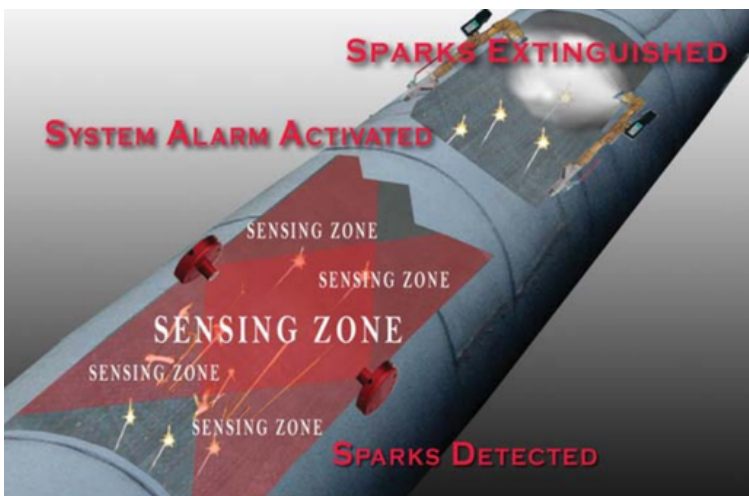
Sistema de Detección Contra Incendios
